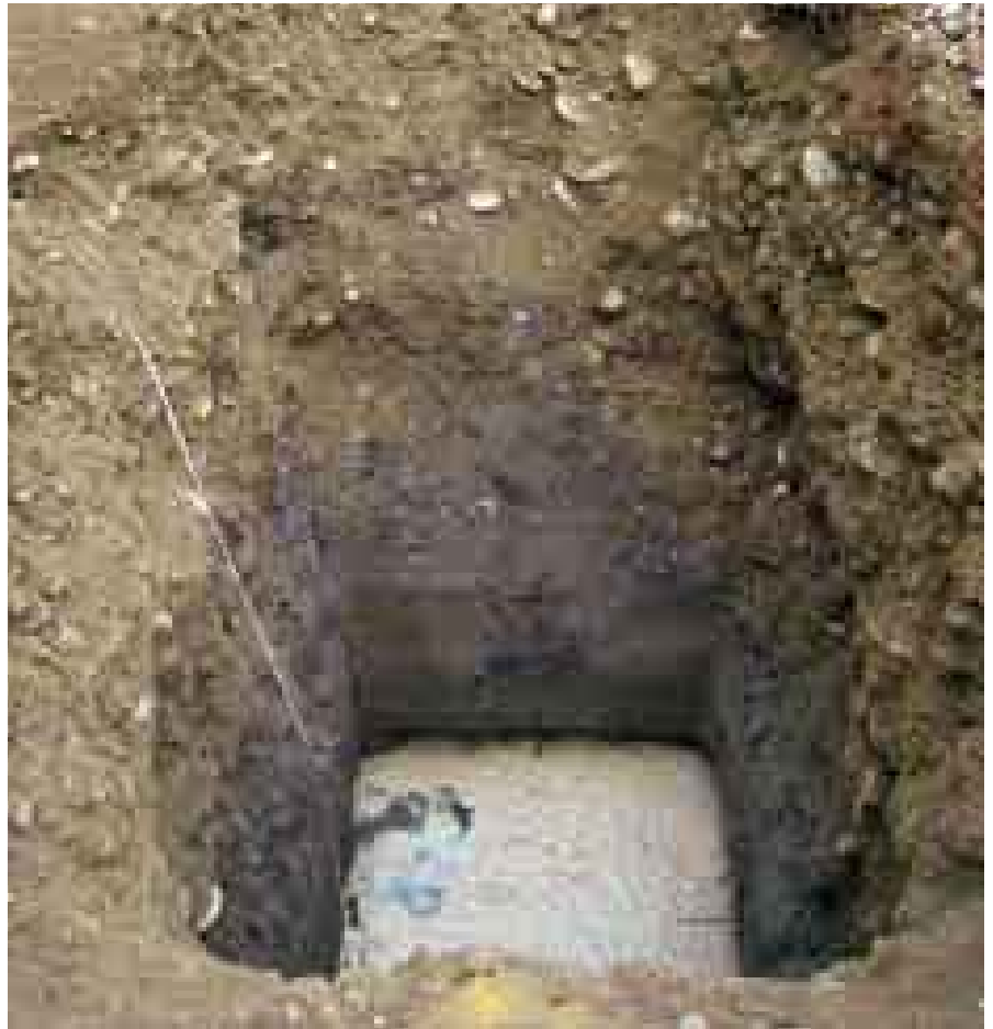
Ökologische Aufwertung Sankt-Vrene-Matten, Bodenanalyse mittels Baggerschlitz
