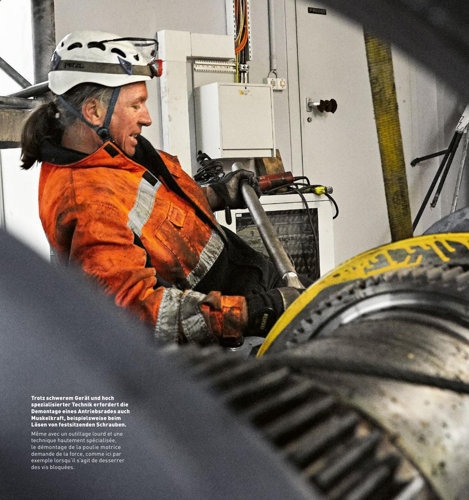
**Trotz schwerem Gerät und hoch spezialisierter Technik erfordert die Demontage eines Antriebsrades auch Muskelkraft, beispielsweise beim Lösen von festsitzenden Schrauben.**
