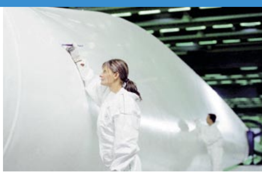
Endkontrolle eines Rotorblattes in einer Vestas-Fabrik
