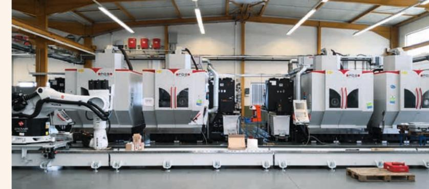
Diese vier CNC Maschinen vom Typ POS Mill H800U sind für die Bearbeitung zuständig.
